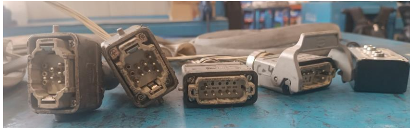
Figura 5. Ejemplo de conexiones eléctricas necesarias para los paneles de freno.
